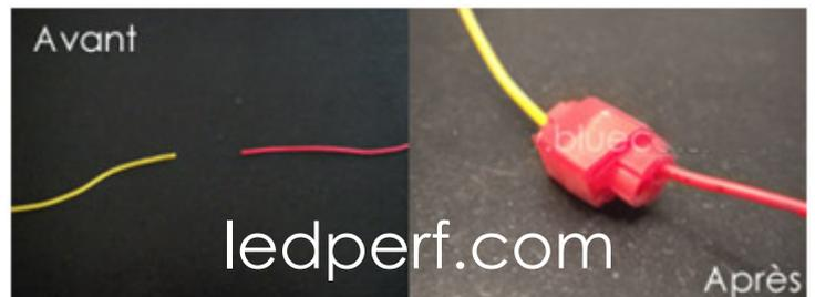
Precaución: Utilice un dominó para cada cable de la cinta. Para cada banda, hay 2 dominós para usar porque hay un cable (+), y un cable (-).
